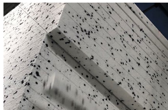
▲ Kantenbearbeitung: Stufenfalz und Nut & Feder werden gefräst. Bearbeitungsreste werden der Wiederverwertung zugeführt. Die hier zu sehenden grau gefärbten Anteile in der EPS-Platte sind durch Rezyklat-Zugaben entstanden.
