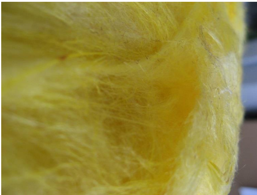
Abbildung 16: Dämmstoff aus Mineralwolle
