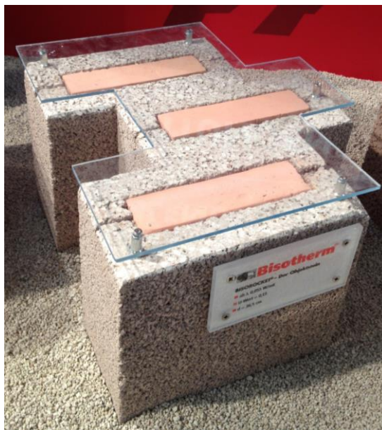
Abbildung 43: Haufwerksporiger Leichtbeton mit Füllung aus Phenolharz-Hartschaum. Bemessungswert der Wärmeleitfähigkeit 0,070 bis 0,055 \text{ W/(m}\cdot\text{K)} – dargestellt ist der sog. Objektstein mit einem Bemessungswert der Wärmeleitfähigkeit von 0,065 \text{ W/(m}\cdot\text{K)} .
