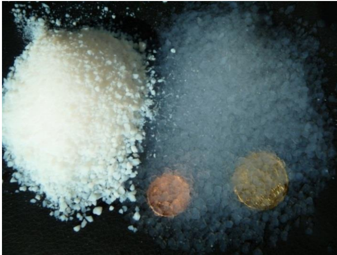
Abbildung 8: Dämmstoff aus Aerogel
