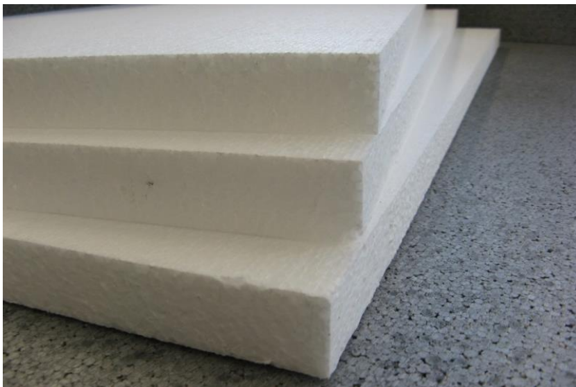
Abbildung 18: Dämmstoffplatten aus expandiertem Polystyrol (EPS)
