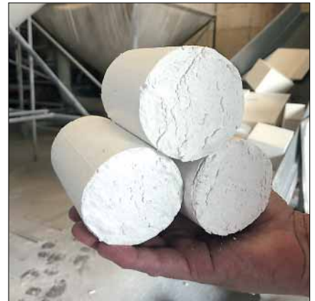
Kompaktierte EPS-Abfälle werden als Leichtzuschlag für Beton, Mörtel oder Estrich verwendet.
