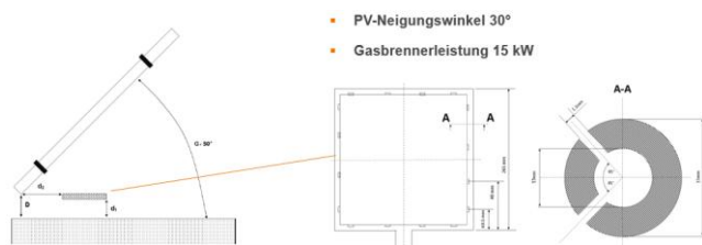
PV-Anordnung, PV-Neigungswinkel und Brennerpositionierung gemäß CLC/TR 50670
